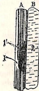
FIG. 306. Corte normal a la cara g_1(010) que contiene simultáneamente las maclas de Carlsbad y de la albita. El individuo A contiene las maclas (1) y (1') de la albita; el individuo B con el cristal A forma la de Carlsbad.
