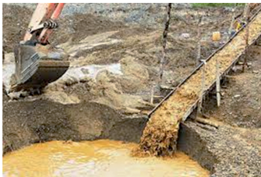
Figura 20.3. La minería de tipo aluvial usa grandes cantidades de mercurio para rescatar el oro de los sedimentos.
