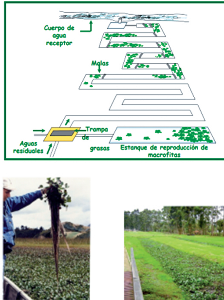
Figura 20.11. Esquema de canales sembrados con Eichhornia crassipes (buchón de agua) para el tratamiento de aguas residuales industriales.
