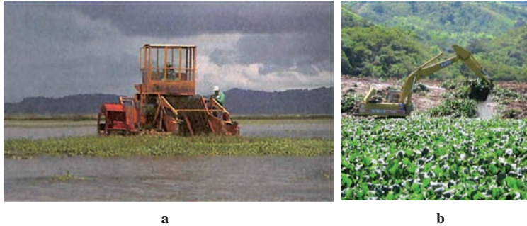
Figura 17.4. Control mecánico de plantas acuáticas a. por cosechadora en laguna de Fúquene (Cundinamarca) y b. retroexcavadora en el Embalse Porce II (Colombia).
